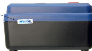
Рисунок 2 - Схема пломбировки от несанкционированного доступа
